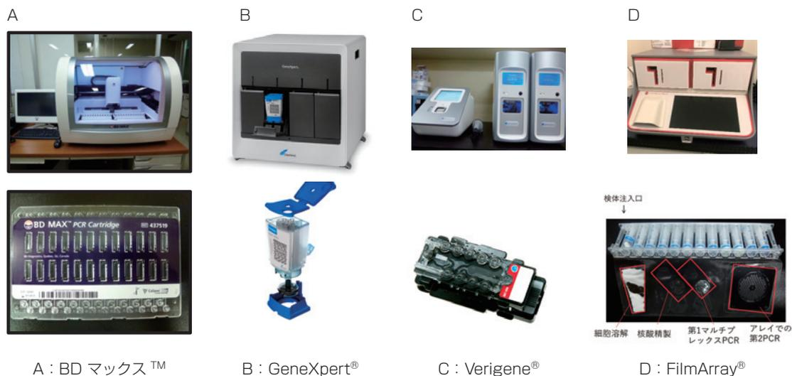
図 1. 全自動遺伝子検査システムの種類
